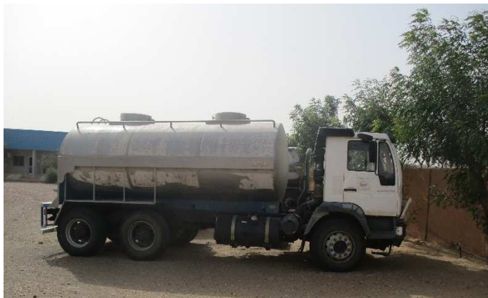
photo 11 Camion-citerne réfrigéré de capacité 10 000 litres qui servait de transport de lait des centres à l'usine à Néma
