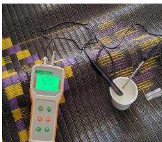
photo 26 – Mesure du PH pour vérifier l'acidité des produits
