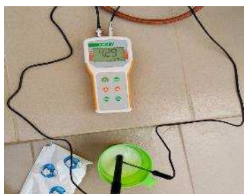
photo 26 – Mesure du PH pour vérifier l'acidité des produits
